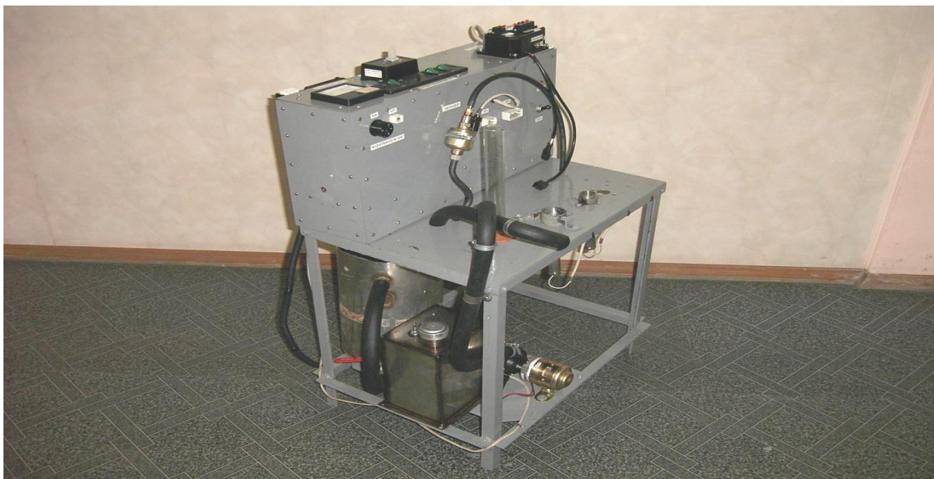
Рис. 13 – Стенд контроля подогревателя
